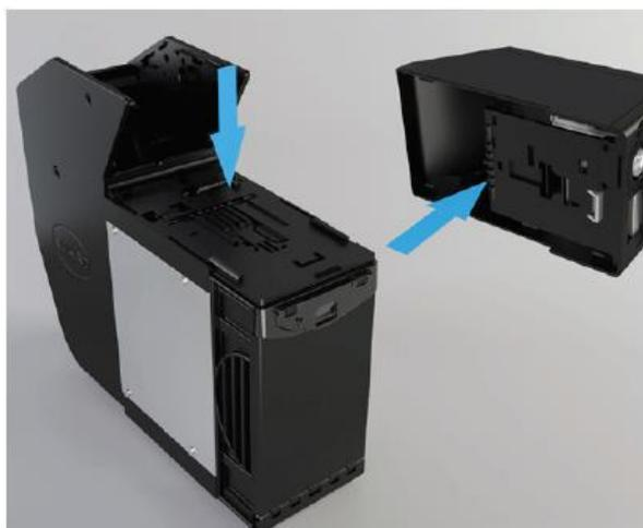
Vérifiez s'il y a un blocage de billets sur le dessus de la Cashbox et en dessous du validateur.
